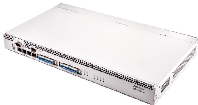
**Платформа SMG-1016M-SIGTRAN** предназначена для трансляции сигнальных и медиа данных между пакетными и традиционными сетями. Прозрачная передача сигнализации SS7 и DSS1 (Q.931) через пакетные сети осуществляется благодаря поддержке протоколов M2UA и IUA из стека SIGTRAN. Управление медиа каналами осуществляется по протоколам H.248/MEGACO или MGCP.
